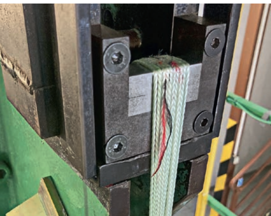
Abb. 4: Kompletter Mantelriss beim UIAA 108 Scharfkantentest. Foto: Tendon, J. Hazda
